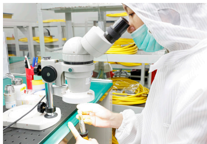
显微镜上安装光纤连接器
